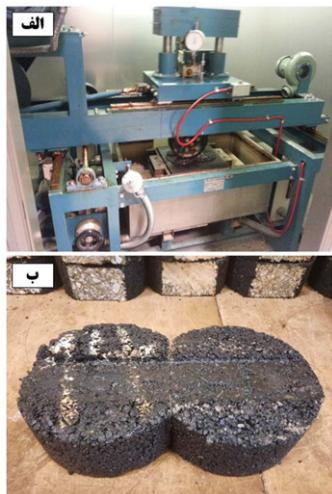
شکل ۶- (الف) دستگاه شیارشدنگی هامبورگ آزمایشگاه فنی و مکانیک خاک (برند tanifuji مدل TR-332) و (ب) تصویر یک نمونه بعد از آزمایش
