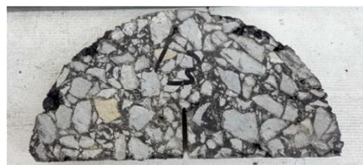
شکل ۳- هندسه نمونه خمش دایره‌ای مصرفی در این مطالعه در این مطالعه چهار نوع مخلوط آسفالتی مختلف بر اساس معیارهای طراحی روسازی ممتاز به منظور ارزیابی مقاومت آن‌ها در برابر شکست تهیه شد. در ابتدا، پیش از
