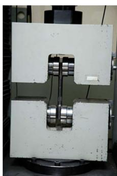
شکل ۷- مدل آزمایشگاهی تحت بارگذاری چرخه‌ای میراگر
