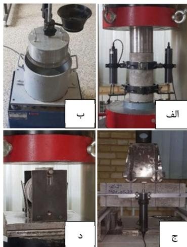
شکل ۳- چینش تست‌های انجام شده، الف: مقاومت فشاری، ب: وی‌بی، ج: مقاومت خمشی، د: مقاومت کشش دو نیم شدگی
