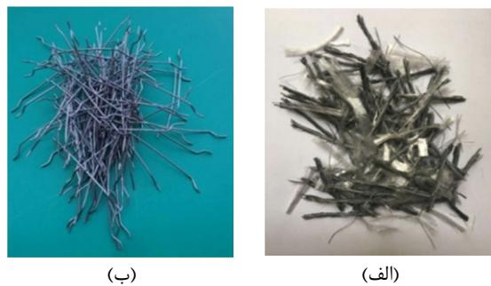
شکل ۷- تصویری از (الف) الیاف کورتا و (ب) الیاف فولادی مورد استفاده
