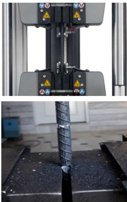
شکل ۶- دستگاه کشش مستقیم میلگرد و نحوه کرنش و گسیختگی میلگرد
