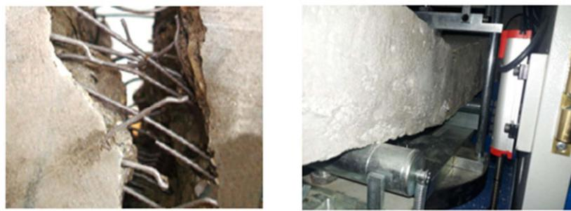
شکل ۱۲ - آزمایش مقاومت خمشی
