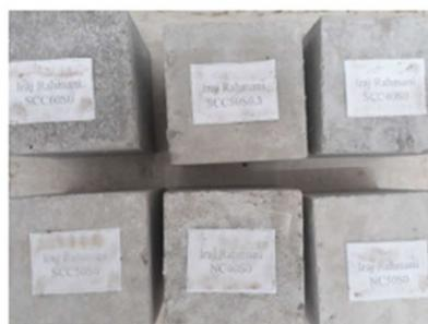
شکل ۶- آزمایش مقاومت فشاری
