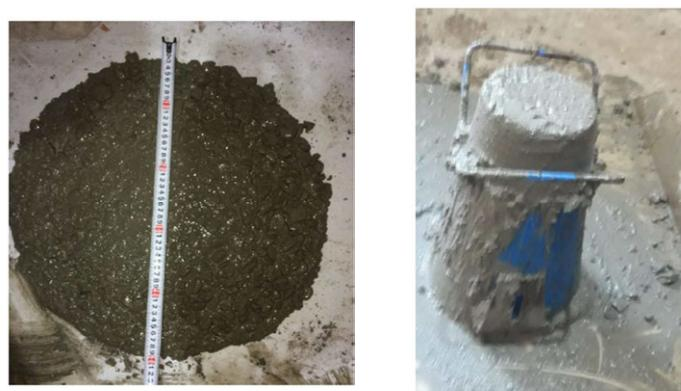
شکل ۴- (الف) آزمایش مخروط اسلامپ و (ب) آزمایش جریان اسلامپ
