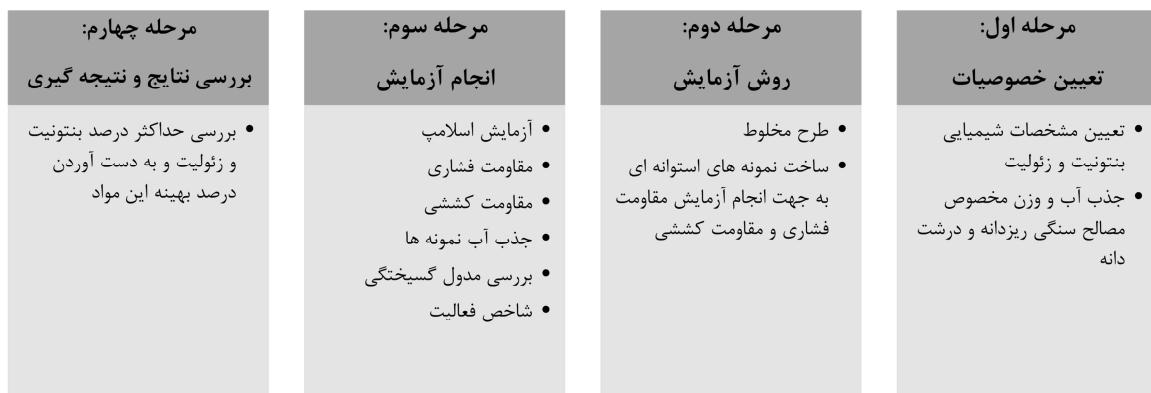
شکل ۱- فلودیاگرام آزمایش
