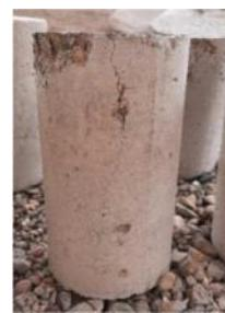
(ج) نمونه تحت آزمایش مقاومت فشاری قرار گرفته
