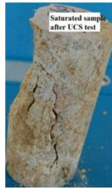
(الف) نمونه اشباع (نمونه شماره ۱) بعد از آزمایش UCS
