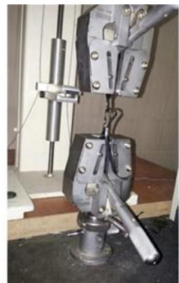
شکل ۳- تست کشش ژئوسل
