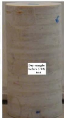
(ت) نمونه خشک (نمونه شماره ۱۴) قبل از آزمایش UCS
