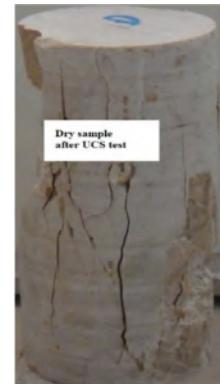
(پ) نمونه خشک (نمونه شماره ۱۴) بعد از آزمایش UCS
