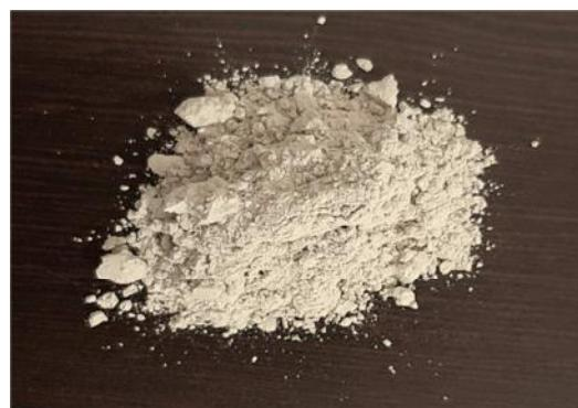
شکل ۳- سرباره کوره ذوب آهن
