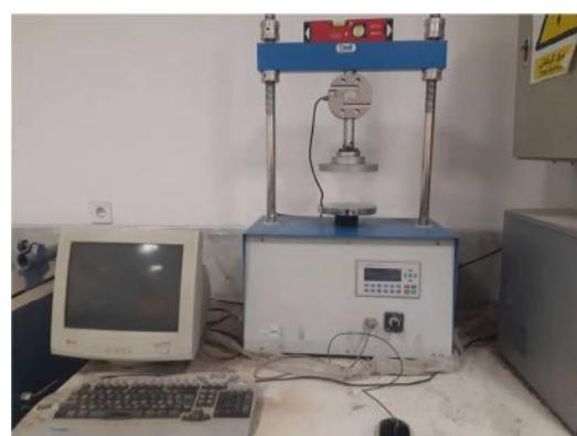
شکل ۶- دستگاه مقاومت فشاری تک محوری
