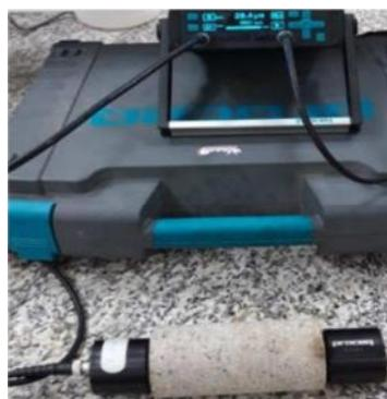
(ب) دستگاه اندازه‌گیری سرعت موج
