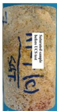
(ب) نمونه اشباع (نمونه شماره ۱) قبل از آزمایش UCS
