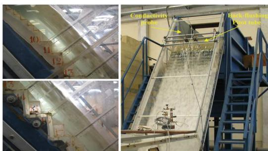
شکل ۵- مدل آزمایشگاهی سریز [۲]
