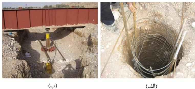
شکل ۵- آماده سازی سیستم بارگذاری صفحه بزرگ مقیاس با استفاده از صفحاتی به قطر ۱۲۰ سانتیمتر، (الف) حفر چاهک و اجرای شمع‌های کششی برای ایجاد تکیه‌گاه و (ب) نصب تیر بارگذاری به همراه تجهیزات آزمایش
