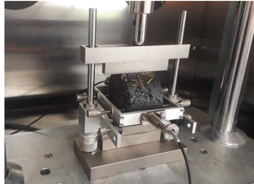
شکل ۲- تجهیزات مربوط به اندازه‌گیری مدول برجهندگی مخلوط‌های آسفالتی
