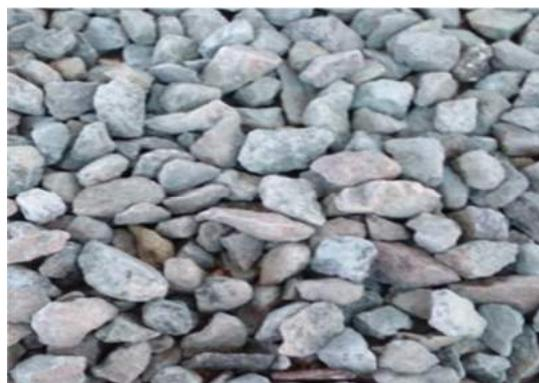
شکل ۲- تصویر نمونه سنگ‌دانه سلیمانیتی مورد استفاده
