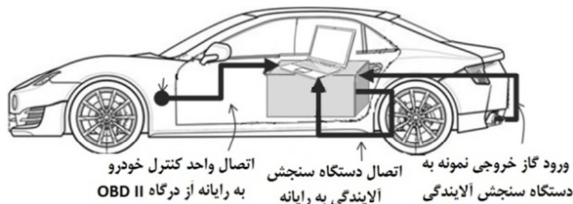
شکل ۳- شماتیک خودرو تجهیز شده به تجهیزات سنجش آلاینده‌گی همراه [۳]
