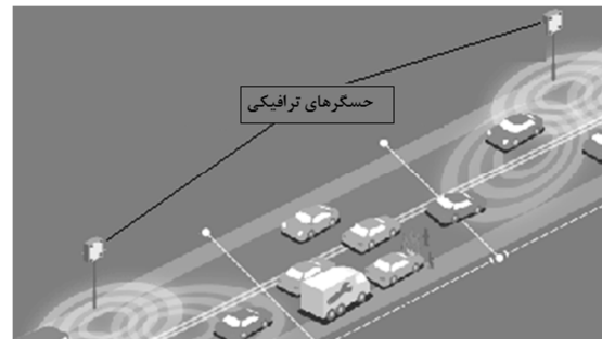
شکل ۶- شماتیک نحوه اندازه‌گیری زمان سفر و سرعت متوسط جریان ترافیک
