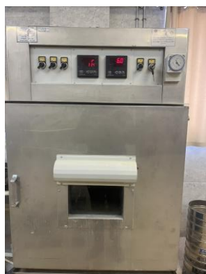
شکل ۳- یخچال جهت انجام آزمایش ذوب و یخبندان
