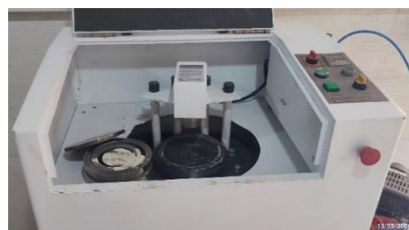
شکل ۱- روش تهیه پودر شیشه (الف) آسیاب فکی (ب) آسیاب دیسکی
