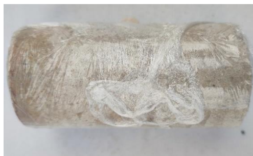
شکل ۳- آماده سازی نمونه های مورد آزمایش مقاومت فشاری تک محوری
