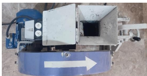
شکل ۱- روش تهیه پودر شیشه (الف) آسیاب فکی (ب) آسیاب دیسکی
