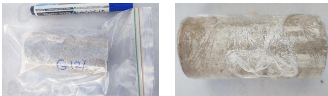
شکل ۳- آماده سازی نمونه های مورد آزمایش مقاومت فشاری تک محوری
