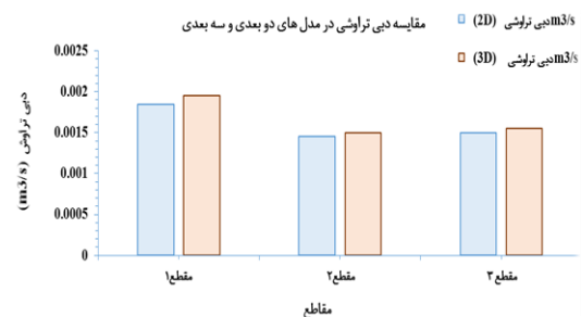
شکل ۴- مقایسه دبی تراوشی در مدل‌های دوبعدی و سه‌بعدی برای سه مقطع عرضی سد آغ‌چای
