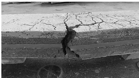
شکل ۱۰- چگونگی شکست نمونه NA150-1
