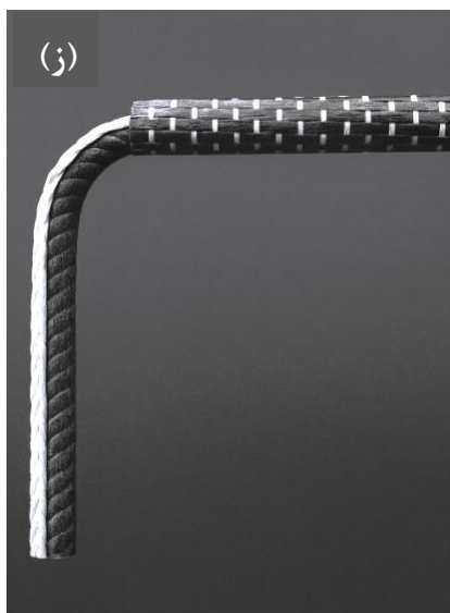
شکل ۲- الف تا و) نحوه ساخت میله HMFRP، ز) مهار انتهایی میله‌های HMFRP [۱]
