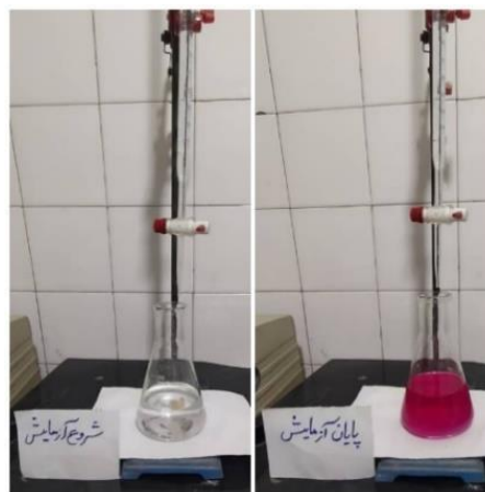
شکل ۴- آزمایش تعیین کربنات کلسیم کل خاک
