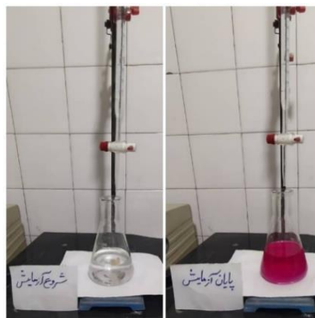
شکل ۴- آزمایش تعیین کربنات کلسیم کل خاک
