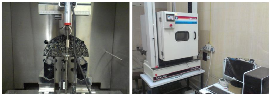
شکل ۶- دستگاه سنتام و نحوه قرارگیری نمونه SCB در دستگاه
