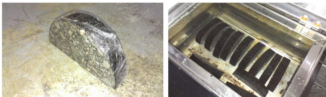
شکل ۴- اشباع کردن نمونه های آسفالتی
