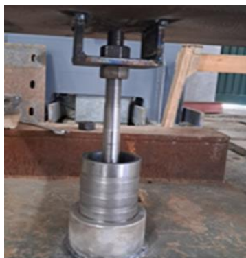
شکل ۸- ستاپ بارگذاری میراگر ویسکوالاستیک استوانه‌ای
