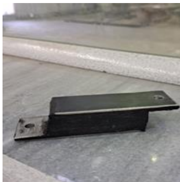
شکل ۳- نمونه میراگر ویسکوالاستیک صفحه ای
