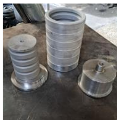
شکل ۷- اجزای میراگر استوانه‌ای و قالب‌ها
