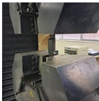
شکل ۴- بارگذاری میراگر ویسکوالاستیک صفحه ای
