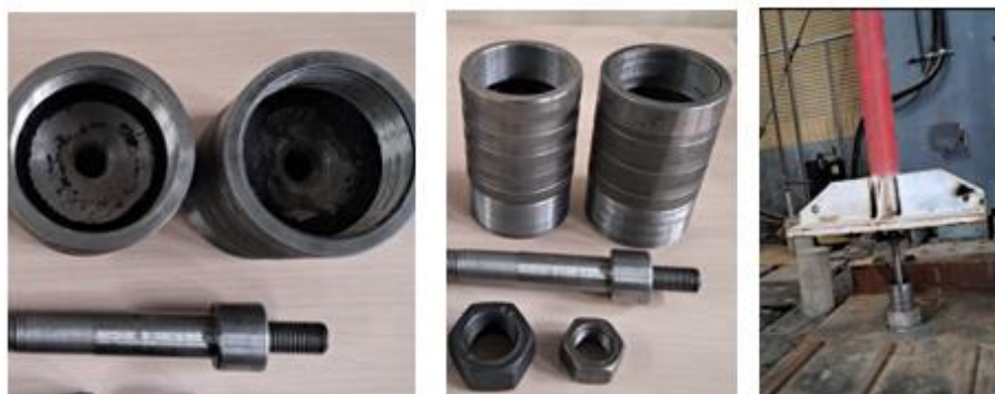
شکل ۱۱- دو میراگر ویسکوالاستیک استوانه‌ای با ضخامت‌های ۵ و ۸ میلی‌متر و جک بارگذاری
