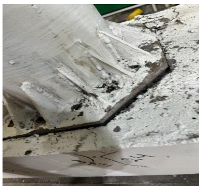
شکل ۶- الگوهای ترک و انتشار آسیب نمونه‌های (الف) نمونه PRC. (ب) نمونه PHST.
