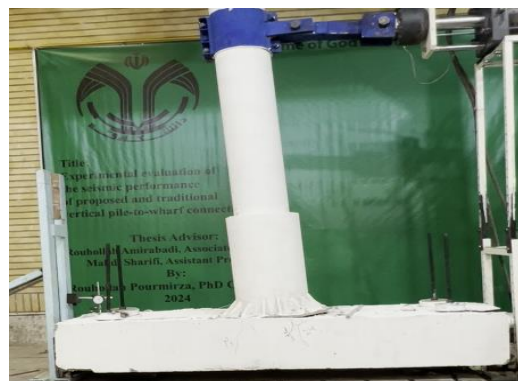
شکل ۶- الگوهای ترک و انتشار آسیب نمونه‌های (الف) نمونه PRC. (ب) نمونه PHST.
