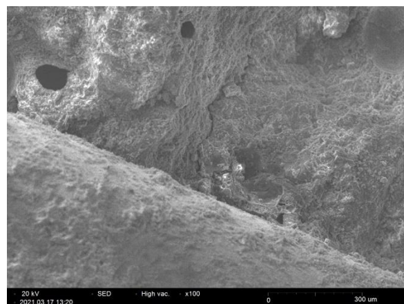
نمای ریزساختار نمونه‌های بتن سبک حاوی ۱٪ الیاف فولادی در دمای ۶۰۰ درجه سلسیوس
