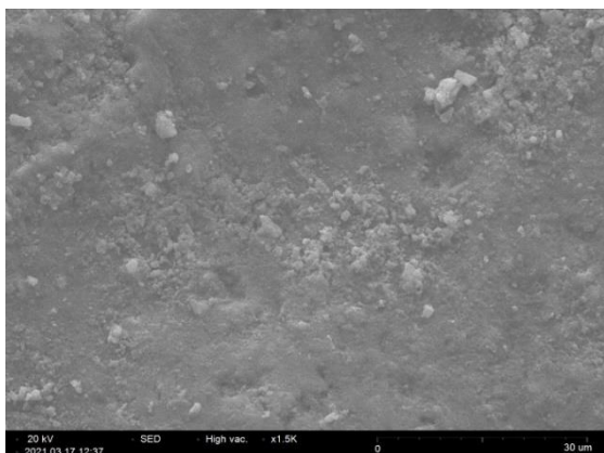
نمای ریزساختار نمونه‌های بتن سبک حاوی ۱٪ الیاف فولادی
