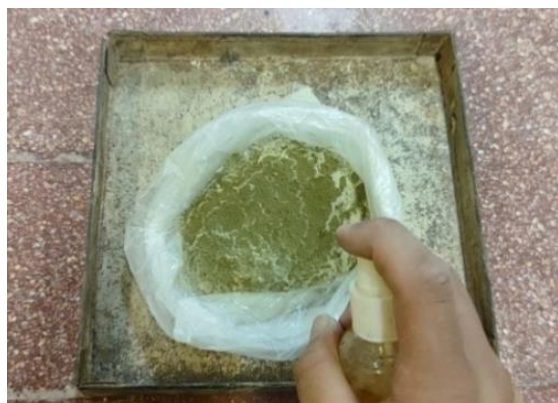
شکل ۶- مرطوب سازی نمونه‌ها با افشانه.
