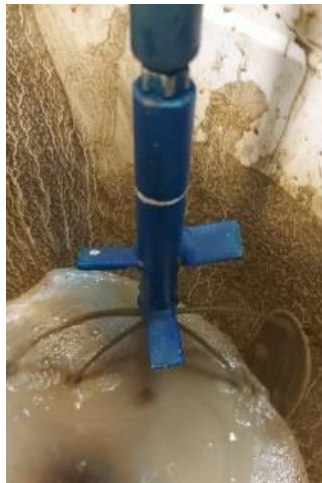
شکل ۸- کالیبراسون میزان بازشدگی شیر تنظیم جریان دوغاب در بیرون از بستر ماسه طی آزمون‌های مقدماتی.
