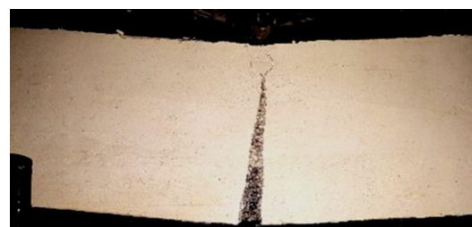
شکل ۸- پدیده‌ی پل‌زدگی الیاف در کائولینیت مسلح.
