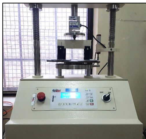
شکل ۴- نمونه تحت آزمایش خمش سه‌نقطه‌ای.
