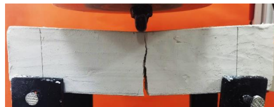
شکل ۶- گسیختگی نمونه‌ی تثبیت شده با ۵ درصد آهک.
