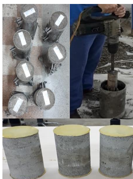
شکل ۳- تصاویری از روند آماده‌سازی نمونه‌های بتن غلتکی
