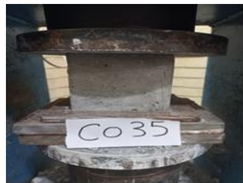
شکل ۴- آزمایش مقاومت فشاری
