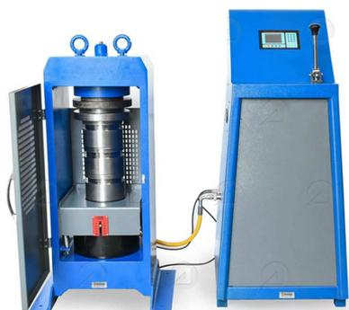
شکل ۸- دستگاه تست مقاومت فشاری
