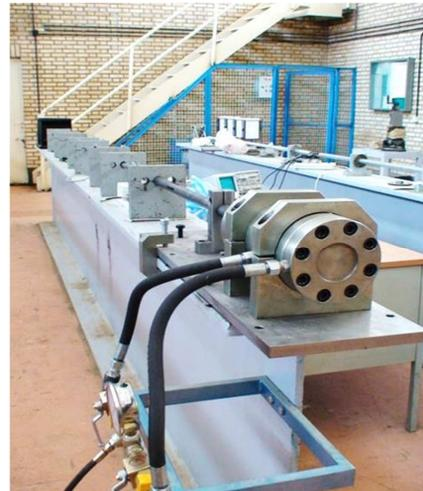
شکل ۹- نمایی از دستگاه آزمایش میله هاپکینسون فشاری
