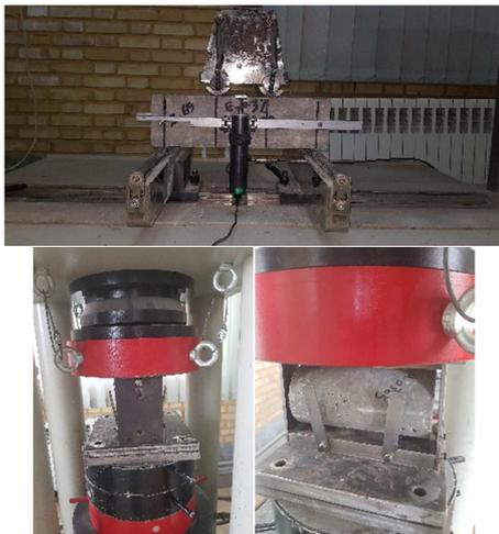
شکل ۸- تصاویر آزمایش مقاومت کششی و خمشی
