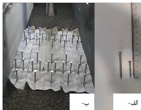
شکل ۶- الف) عکس میخ‌های مورد استفاده و ب) آرایش قرارگیری میخ و ژئوتکستایل در داخل نمونه آزمایشگاهی
