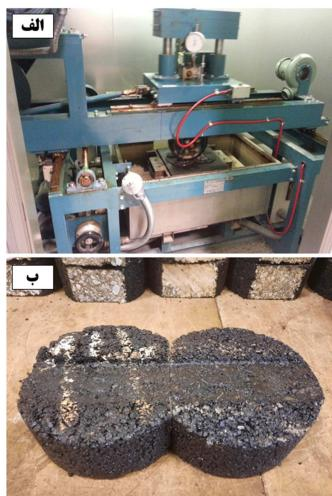
شکل ۶- (الف) دستگاه شیارشدگی هامبورگ آزمایشگاه فنی و مکانیک خاک (برند tanifuji مدل TR-332) و (ب) تصویر یک نمونه بعد از آزمایش
