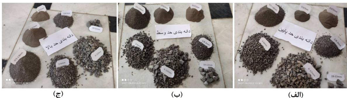
شکل ۲- دانه‌بندی (الف) حد پایین، (ب) حد وسط، (ج) حد بالا در مخلوط سنگدانه‌ها
