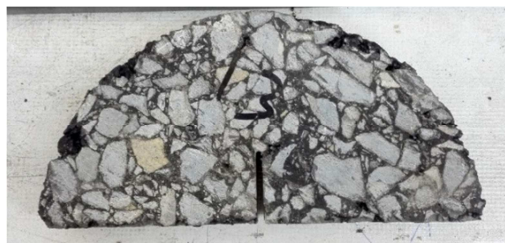
شکل ۳- هندسه نمونه خمشی دایره‌ای مصرفی در این مطالعه
