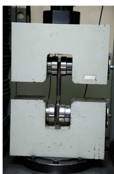
شکل ۷- مدل آزمایشگاهی تحت بارگذاری چرخه‌ای میراگر
