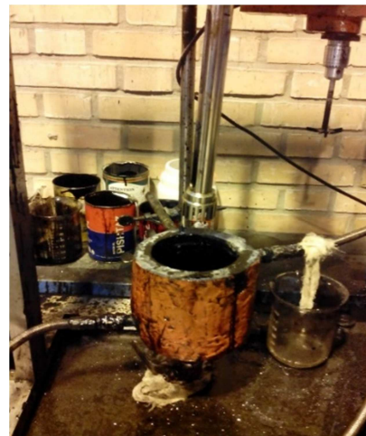
شکل ۱- دستگاه همزن برای اختلاط قیر با افزودنی
