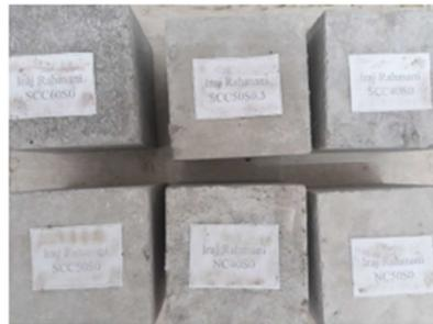
شکل ۶- آزمایش مقاومت فشاری
