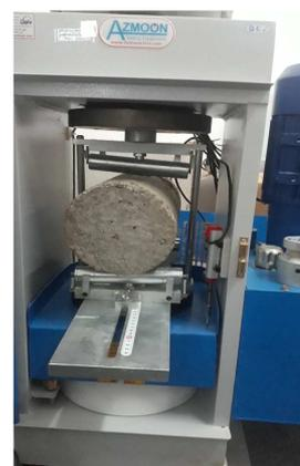
شکل ۹- آزمایش مقاومت کششی
