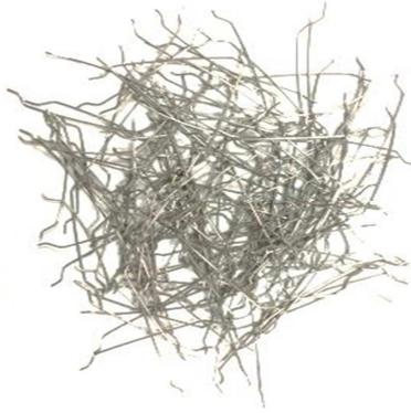
شکل ۲- الیاف فولادی مصرفی
