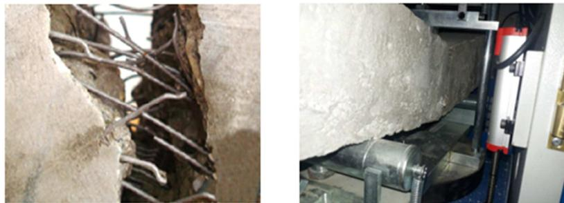
شکل ۱۲- آزمایش مقاومت خمشی
