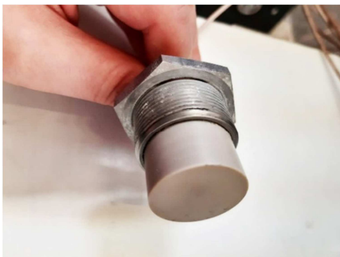
شکل ۱۰- نمایی از حسگر جابه‌جایی غیرتماسی استفاده شده
