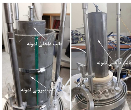
شکل ۱۵- قالب‌های مورد استفاده برای نمونه‌سازی
