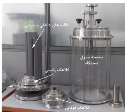
شکل ۵- تصویری از قطعات مجزای دستگاه استوانه توخالی
