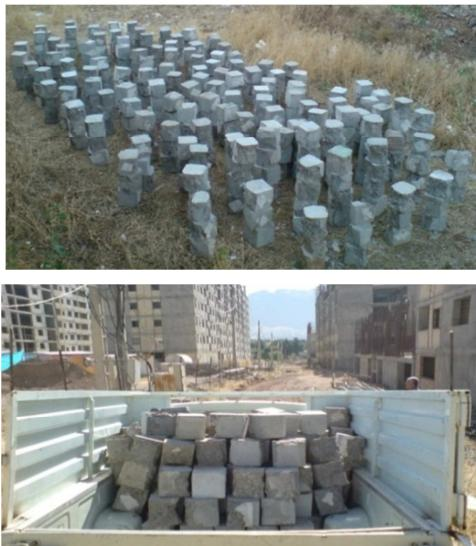
شکل ۴- نمونه‌های دپو شده مکعبی شکل بتن قدیمی و انتقال به کارخانه سنگشکن
