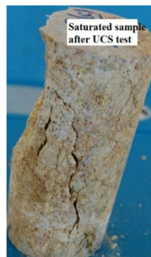
(الف) نمونه اشباع (نمونه شماره ۱) بعد از آزمایش UCS
