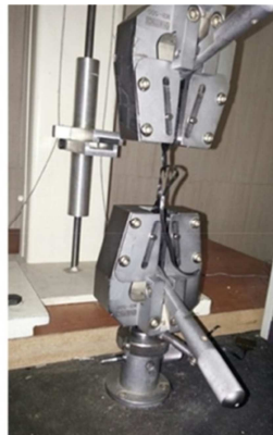
شکل ۳- تست کشش ژئوسل
