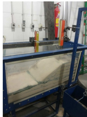
شکل ۵- مدل شیروانی ساخته شده
