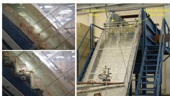
شکل ۵- مدل آزمایشگاهی سرریز [۲]
