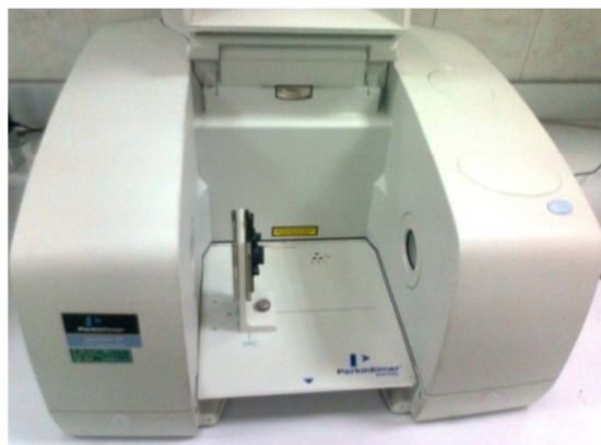
شکل ۱۰- نمونه دستگاه اسپکتروفوتومتر مورد استفاده در
