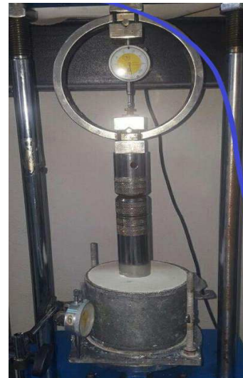
شکل ۳- تصویری از نحوه انجام آزمایش CBR
